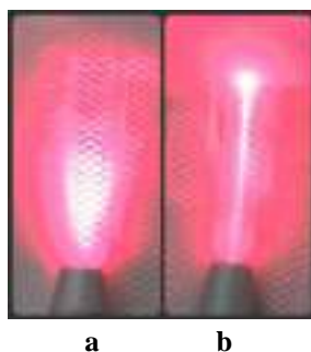
Figura 8 – Laser vermelho 660nm (L1) sendo emitido quando a ponteira convencional está acoplada na extremidade da caneta (a) e quando a fibra óptica está acoplada (b) (Arquivo pessoal da autora).
