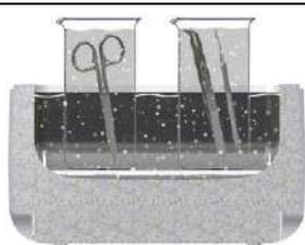
A cuba de inox recebe somente água pura ou diluída em solução específica para melhor cavitação, sendo que os materiais a serem limpos são acondicionados em um béquero com solução de limpeza que é colocado na cesta plástica no interior da cuba de inox.
