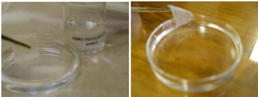
Detalhe da fase de Hidratação da membrana GenDerm com soro fisiológico (esq). Aspecto flexível da membrana após hidratação (dir).
